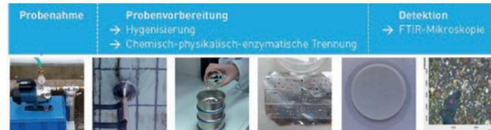
Abbildung 1: Analytik von Mikroplastikpartikeln aus Abwasserproben.
